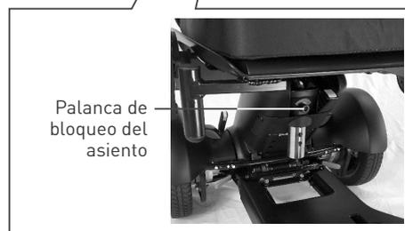
3. Agarre los reposabrazos y levante el ensamblaje del asiento para extraerlo del chasis trasero.
