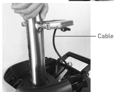
5. Introduzca el tornillo que extrajo en el paso 3 en el orificio que corresponda a la altura deseada y apriételo bien.
