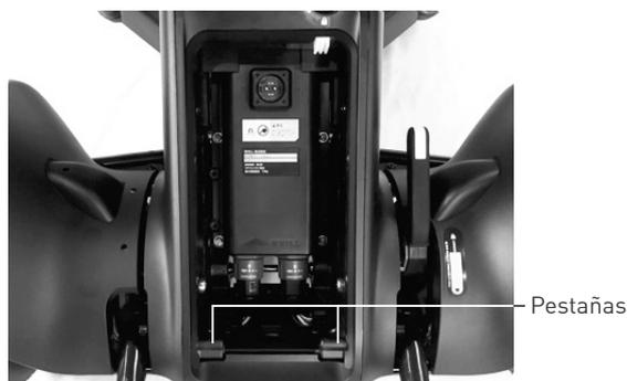
2. Presione hacia dentro la parte superior de la batería para instalarla.
