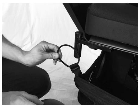
2. Tire hacia usted la palanca de bloqueo del asiento situada en la parte inferior del asiento.
