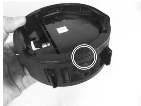
8. Repita los pasos 2-7 e instale la cubierta con forma de anillo en el ensamblaje del lado opuesto del mismo modo.
