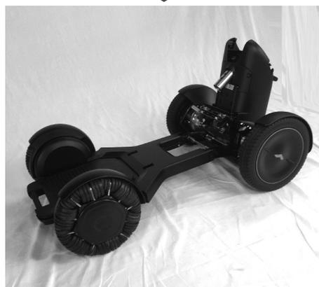
2. Incline lentamente el chasis trasero hacia delante y conéctelo con el delantero.
