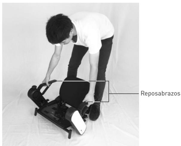
3. Encaje el ensamblaje del asiento directamente en su sitio mientras comprueba la posición de la tija del asiento a partir del orificio de inspección del ensamblaje.
