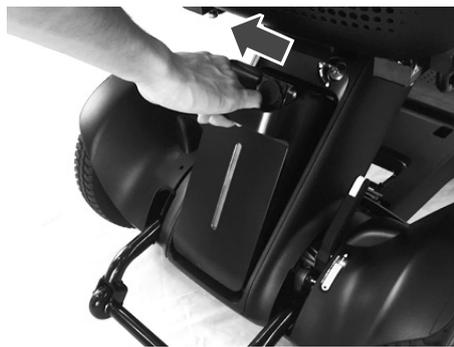
**2. Retire la cubierta del brazo.**
