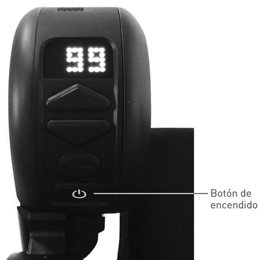
Cuando el dispositivo se enciende, primero aparece el logotipo de WHILL en la pantalla y, a continuación, se muestra el ajuste actual de velocidad. Después de un rato, la pantalla cambia y muestra el indicador del nivel de carga de la batería.
