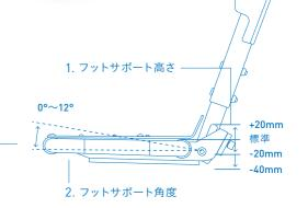
高さ・角度はフィットするように調整できます。 1. フットサポート高さ:-40,-20,0,+20mm 2. フットサポート角度:0°~12°
