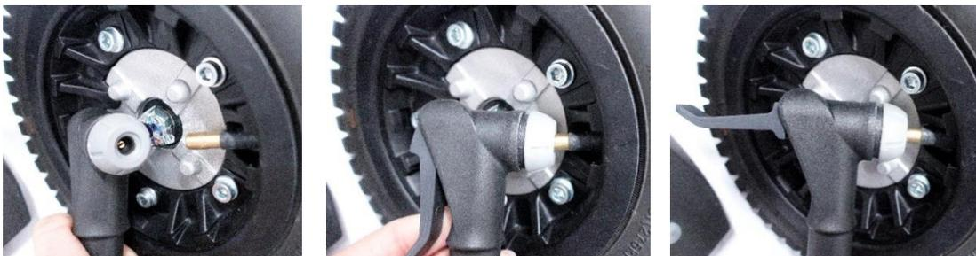
空気入れの口金にタイヤのバルブを接続し、レバーを操作してロックします。
