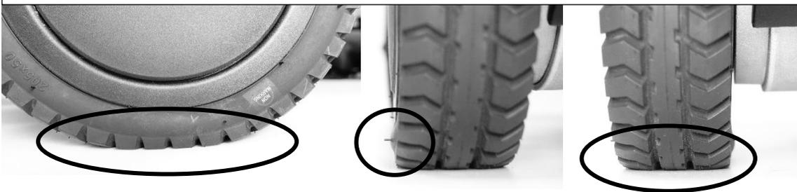
空気が抜けていたらタイヤにたるみが生じて接地面が平べったくなる
