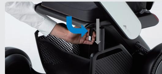
Empuje hacia abajo la palanca de liberación del asiento hasta la posición vertical y fije el respaldo del cojín a la base del asiento.
