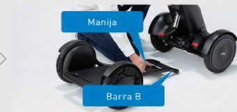
Agarre la manija cerca del centro de la base de tracción delantera y desconecte la Barra B en un extremo de la base de tracción delantera del gancho de la base de tracción trasera.
