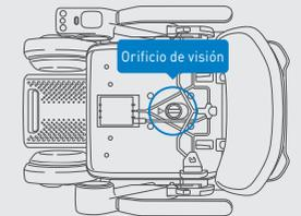
Use el orificio de visión para alinear y colocar el conjunto del asiento en la tija del asiento.
