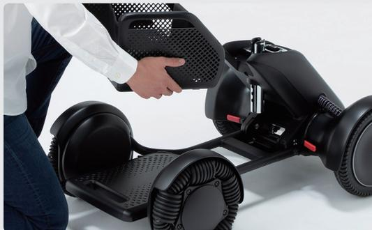
Alinee los ganchos del fondo de la cesta portaobjetos con el bastidor de la base de tracción delantera, y luego empuje la cesta portaobjetos hacia abajo. Empuje la parte plana del fondo de la cesta hasta que haga clic.
