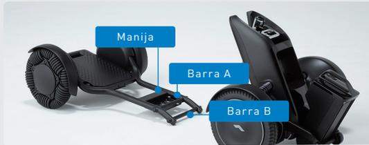
Agarre la manija cerca del centro de la base de tracción delantera mientras inclina la base de tracción delantera del gancho de la base de tracción trasera. Luego, alinee la Barra B con el gancho de la base de tracción trasera.
