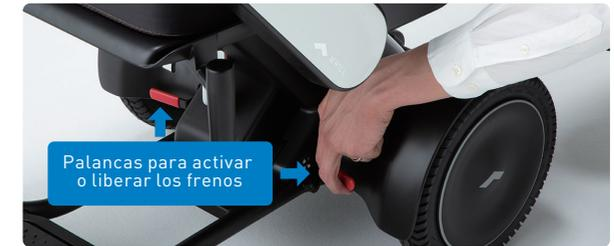
Levante ambas palancas de liberación del freno para volver a accionar los frenos.
