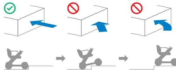
Deténgase cuando las ruedas delanteras choquen con el escalón.
