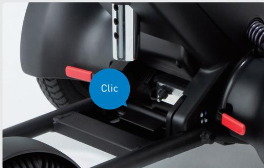
Incline lentamente la base de tracción trasera hacia adelante y conéctela a la base de tracción delantera. La manija de liberación de la base de tracción trasera se engancha a la Barra A de la base de tracción delantera. Se oír un clic cuando las dos partes estén correctamente conectadas.
