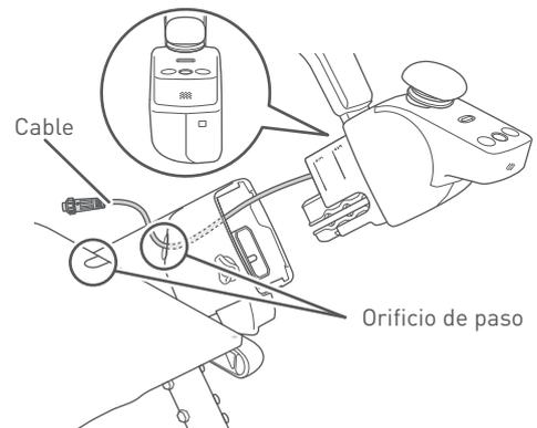
2. Instale el reposabrazos con el controlador en el lado izquierdo del dispositivo.
