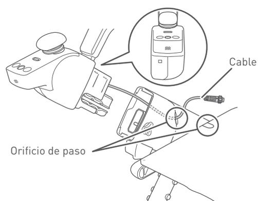
2. Instale el reposabrazos con el controlador en el lado derecho del dispositivo.
