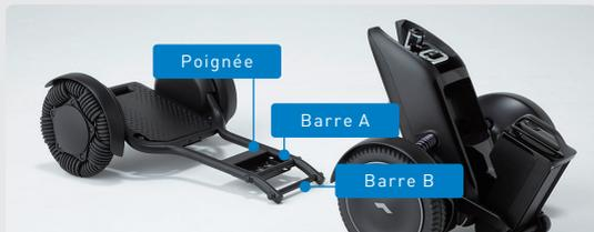
Saisissez la poignée située près du centre de la base de traction avant tout en inclinant la base de propulsion arrière. Aligned ensuite la barre B avec le crochet de la base de propulsion arrière.
