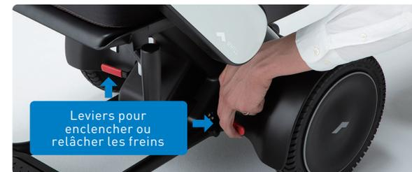
Pour réenclencher les freins, relevez les deux leviers de débrayage.
