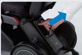
Appuyez sur le bouton de déverrouillage de la batterie. Saisissez la poignée et tirez-la pour retirer la batterie.
