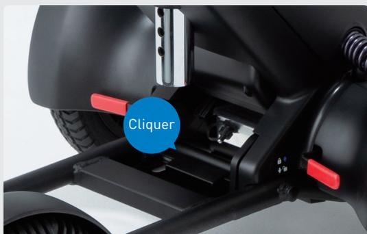
Inclinez doucement la base de propulsion arrière vers l'avant et connectez-la à la base de traction avant. La poignée de déverrouillage de la base de propulsion arrière s'enclenche sur la barre A de la base de traction avant. Un déclic retentit lorsque les deux pièces sont correctement connectées.
