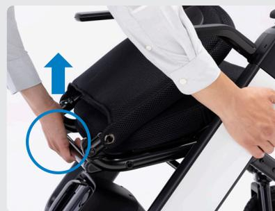
Afferrare il tubo del telaio sul retro del sedile e tirarlo verso l'alto mentre si tiene premuto il tasto di sblocco.
