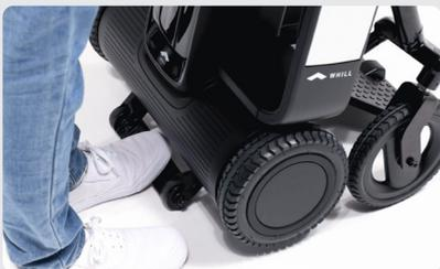
Sostenendo il pedale che collega le due rotelle anti-ribaltamento si impedisce che il dispositivo si muova quando è aperto.
