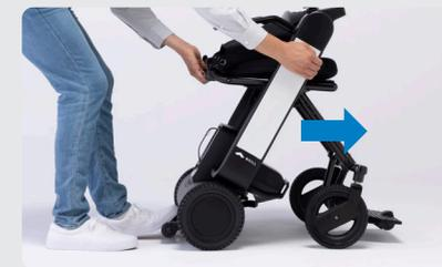
Abbassare il tubo del telaio del sedile mentre si tiene premuto il tasto di sblocco per aprire il dispositivo. Quando inizia ad aprirsi, togliere le mani dal pulsante.
